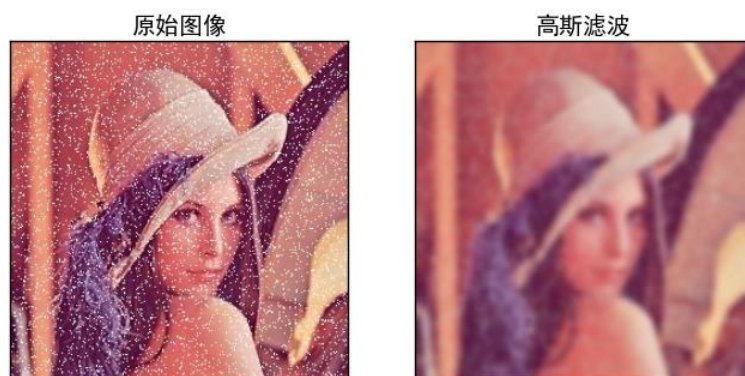
图 23-12 高斯滤波 15 \times 15 核的处理
