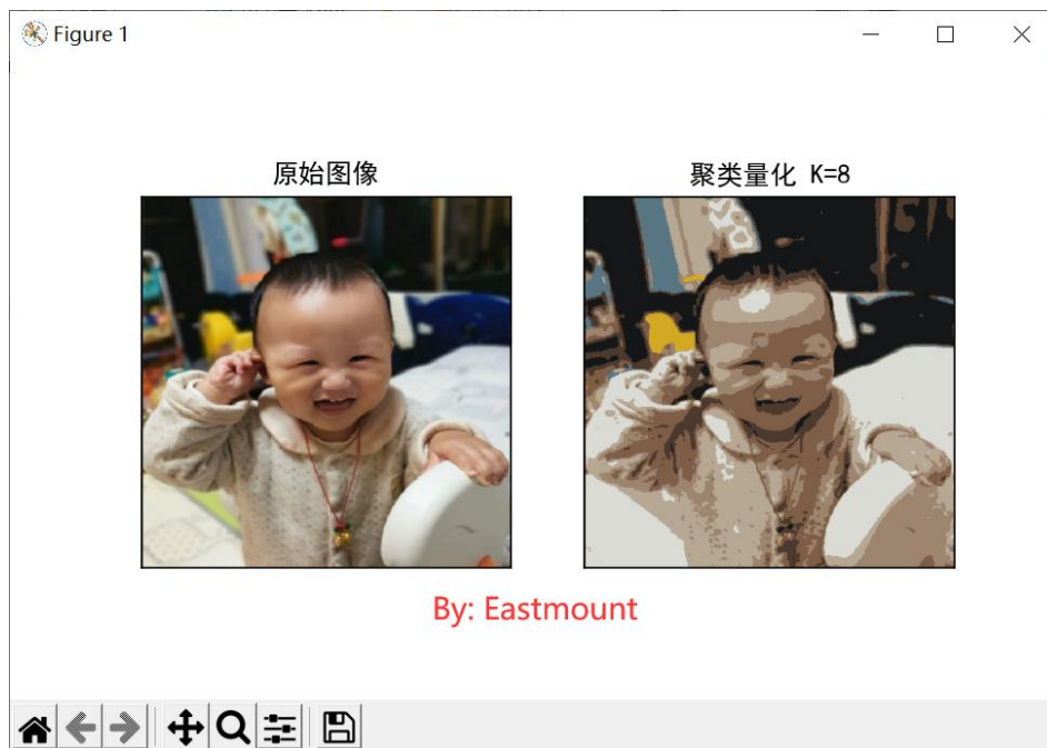
图 8-5 K-Means 量化处理彩色图像
