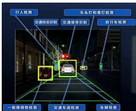
图 45-13 车辆检测示例
