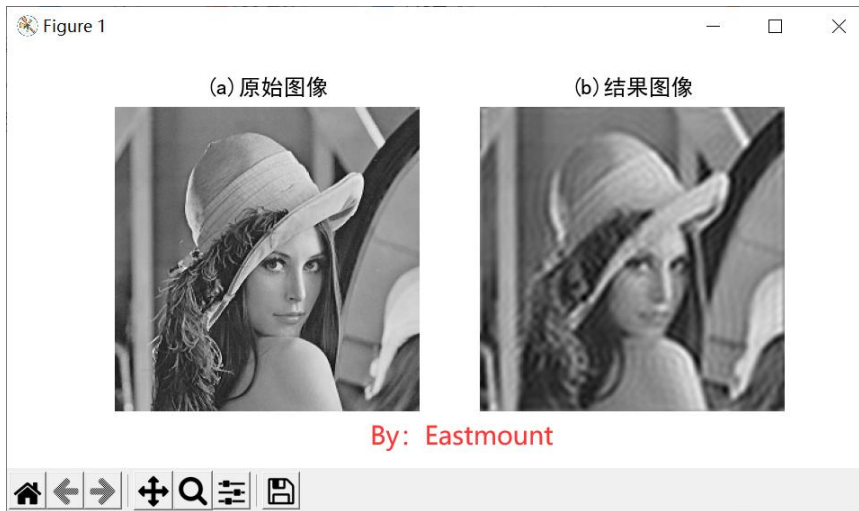
图 32-13 低通滤波器模糊处理
