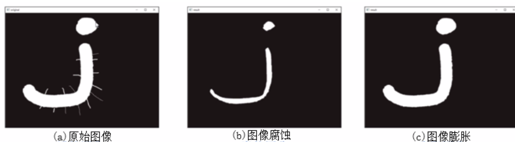
图 15-5 图像腐蚀和膨胀操作对比图
