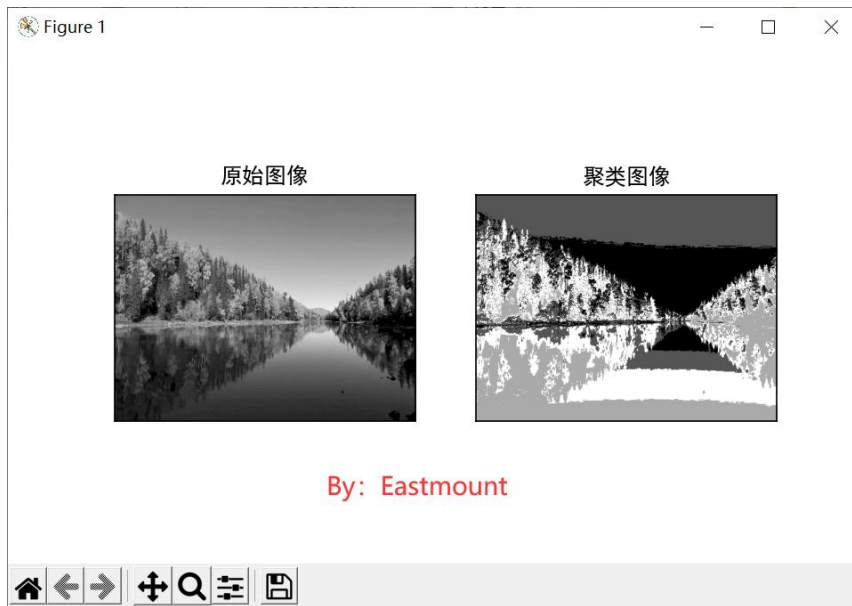
图 29-4 灰度图像 K-Means 聚类处理
