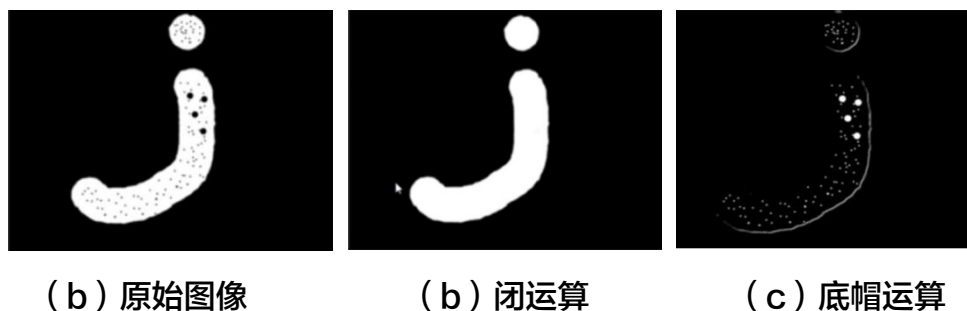
图 17-8 图像底帽运算原理图
