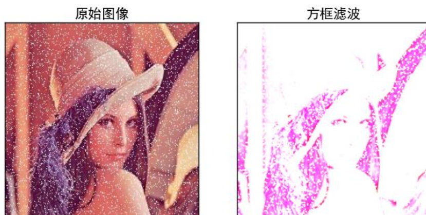
图 23-8 图像 2 \times 2 核的非归一化方框滤波处理
