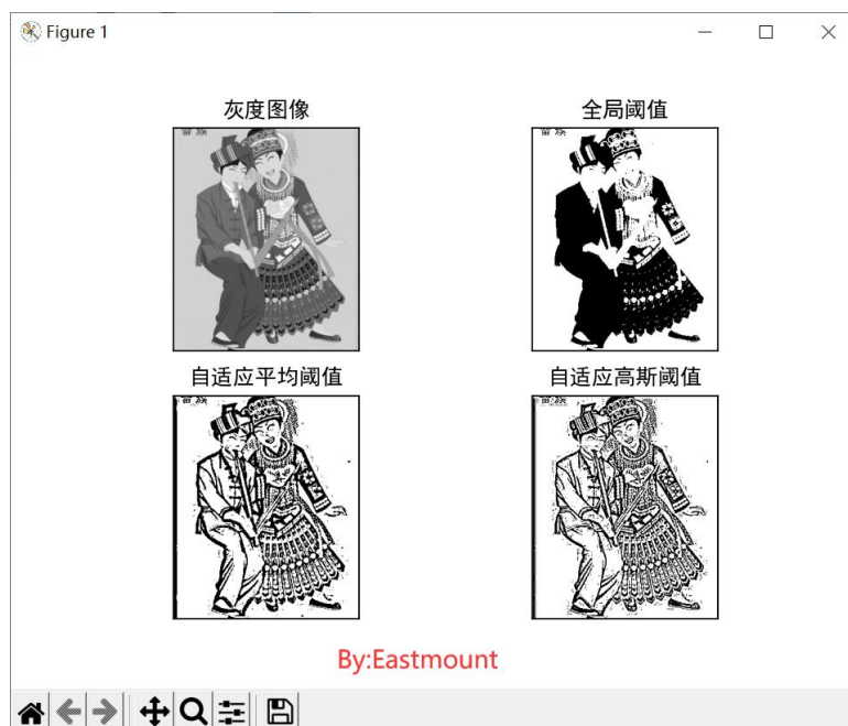
图 14-8 图像自适应阈值化处理对比结果
