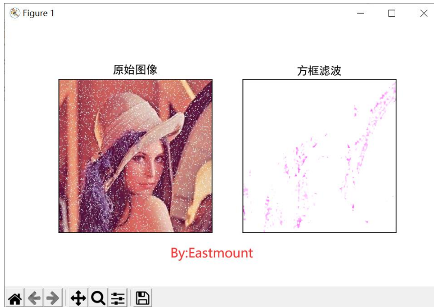
图 23-7 图像 3 \times 3 核的非归一化方框滤波处理
