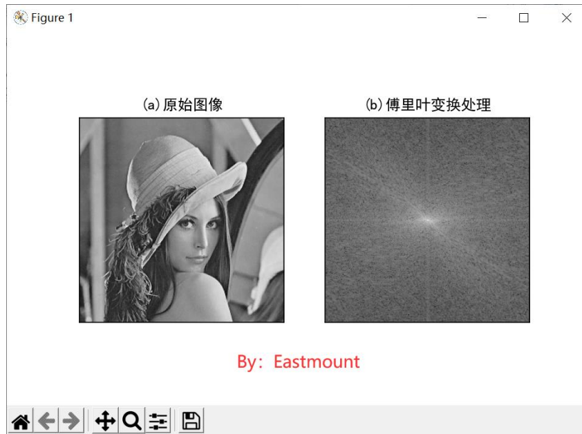
图 32-2 OpenCV 傅里叶变换对比图
