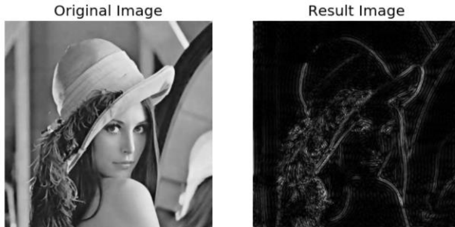
图 32-9 高通滤波器提取边缘轮廓
