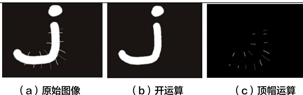
图 17-1 图像顶帽运算原理图
