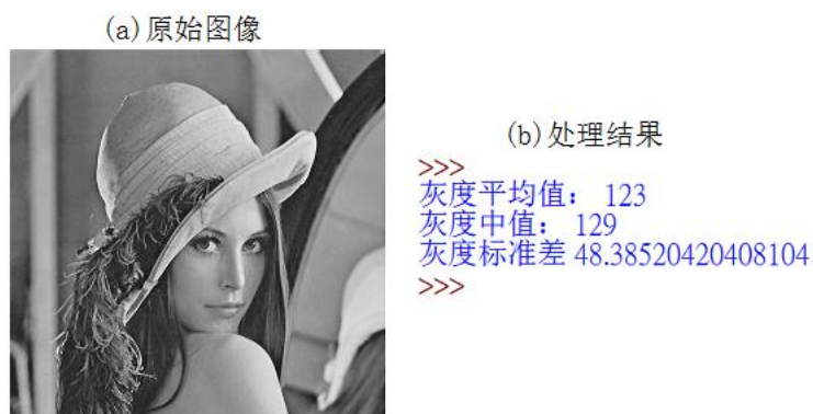
图 20-3 图像平均值、灰度中值和灰度标准差计算
