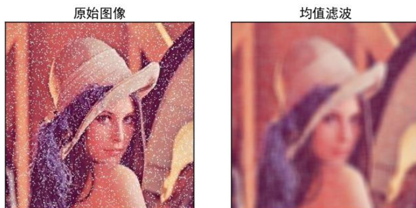
图 23-6 图像 10 \times 10 核的均值滤波处理
