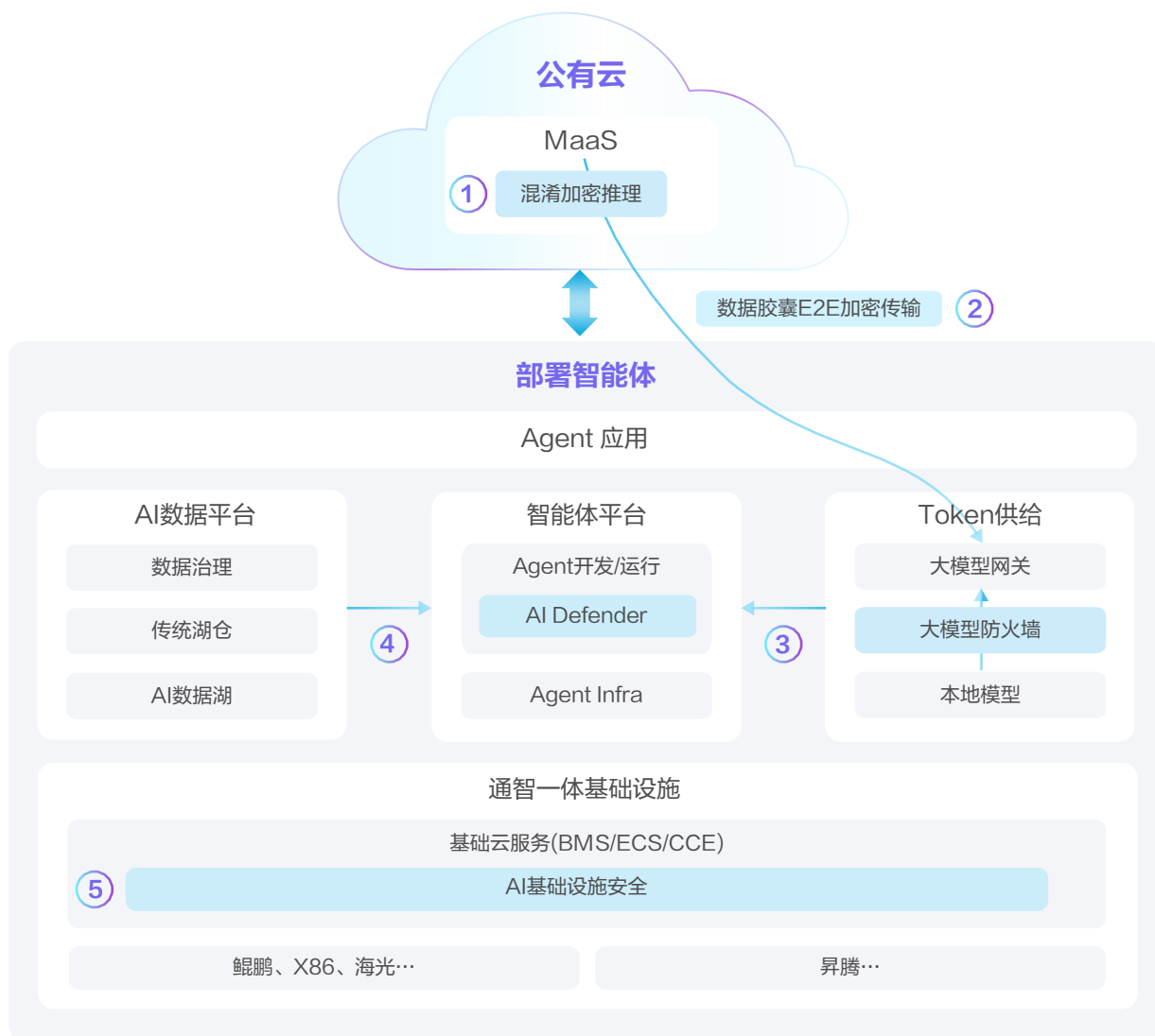
图5.1 混合云智能体安全架构
