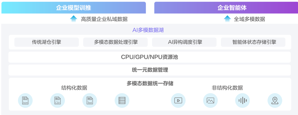
图3.1 AI多模数据湖架构
