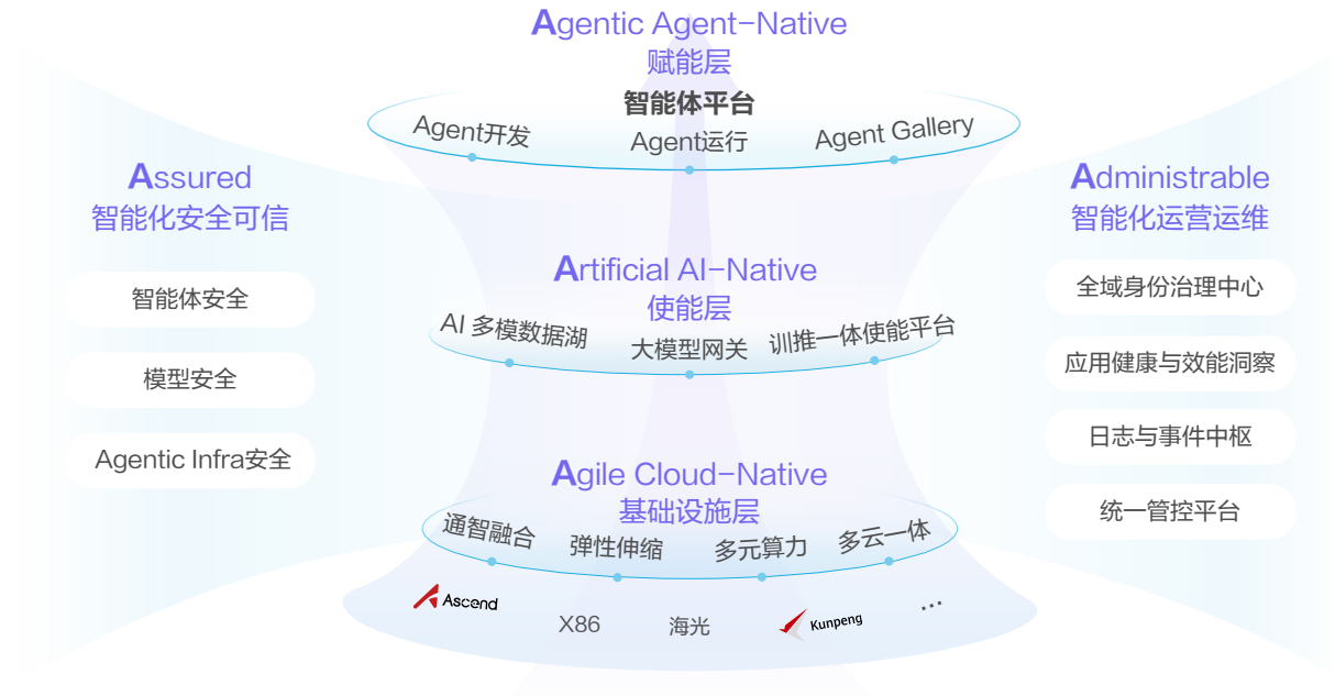
图1.2 企业面向智能体的混合云架构
