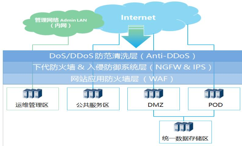
华为云根据业务功能和网络安全风险将数据中心划分为多个安全区域，实现物理和逻辑控制并用的隔离手段，提升网络面对入侵和内鬼的分区自我保护和容错恢复能力<sup>1</sup>。在这里介绍以下五个重要安全区域：
