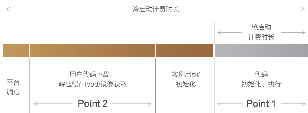
图 4： 冷热启动下的 计费时长及优化点
