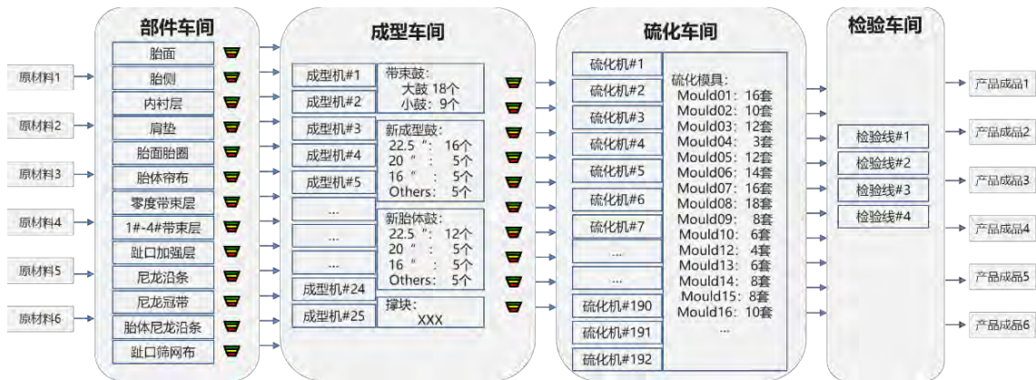
图4.4 轮胎生产流程示意图
