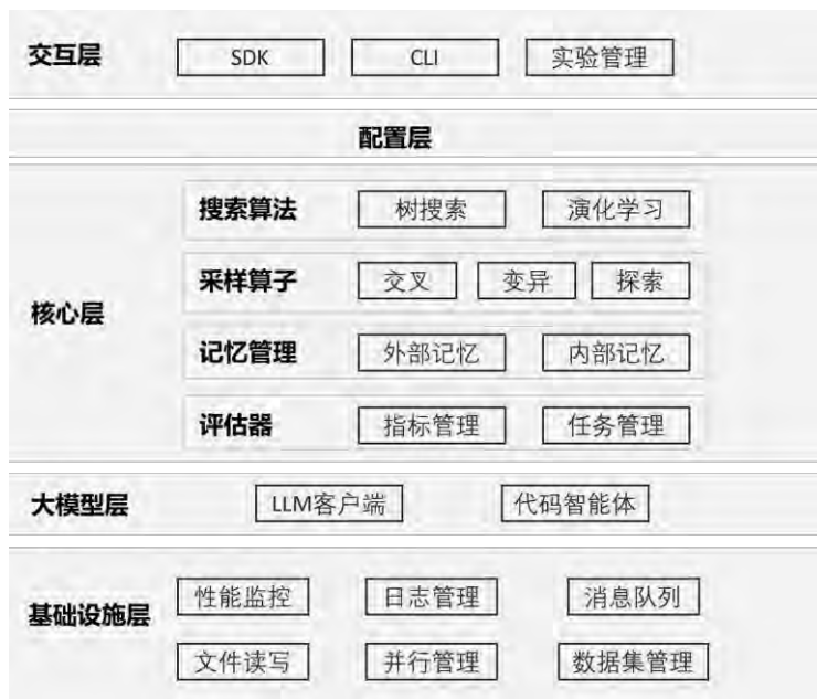
图2.50 基于大模型的算法发现软件架构
