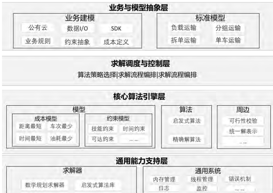
图3.9 运输计划求解器软件架构图
