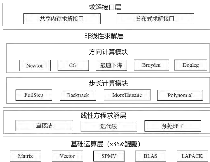
图2.37 非线性方程组求解器软件架构
