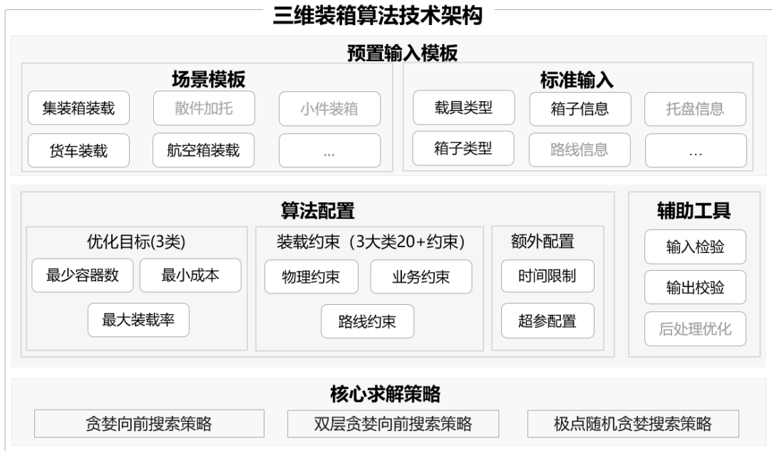
图3.15 三维装箱求解器技术架构图
