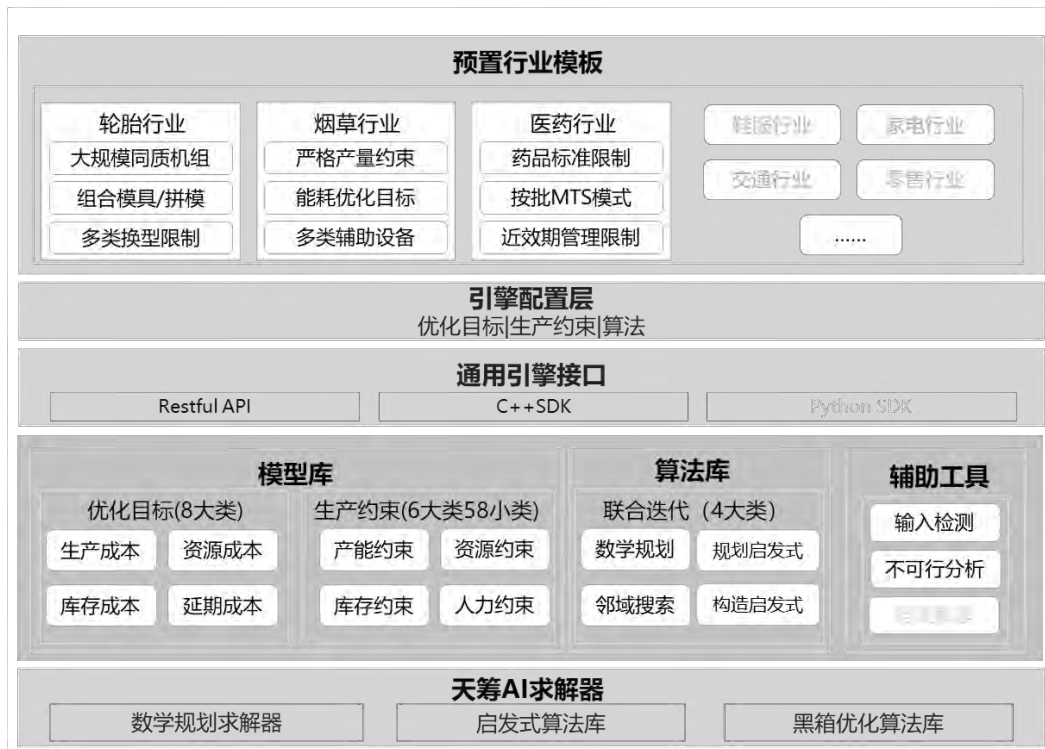
图3.1 批量计划求解器技术架构图
