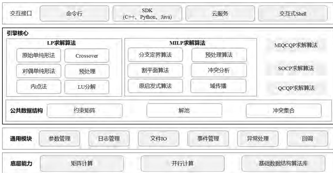
图2.1 数学规划求解器软件架构
