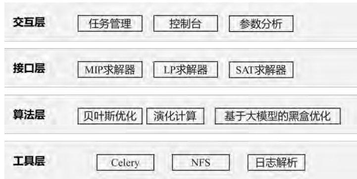
图2.42 求解器超参优化软件架构
