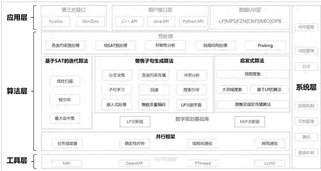
图2.9 约束规划求解器软件架构
