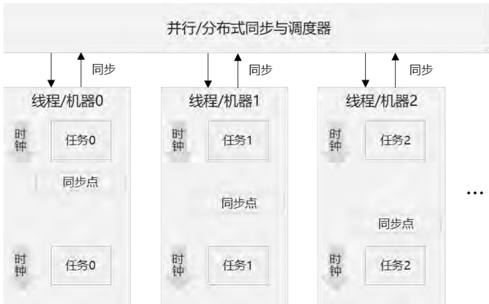
图2.17 约束规划求解器并行架构
