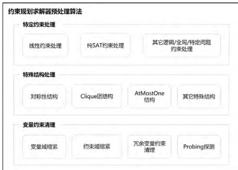
图2.12 约束规划求解器预处理算法地图
