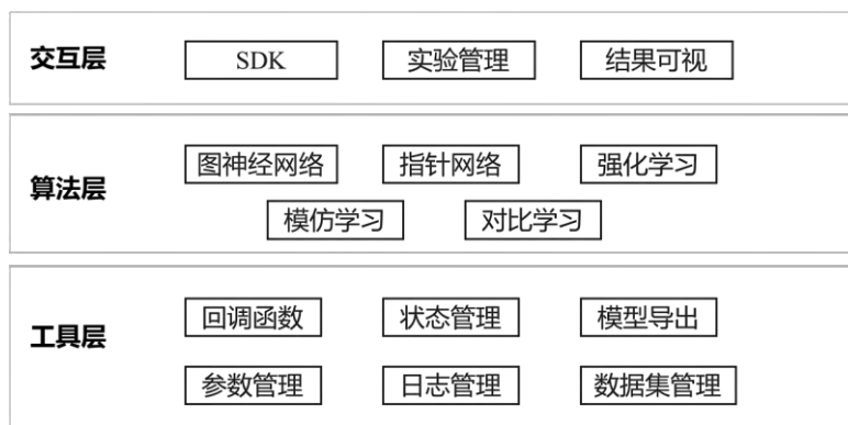
图2.46 求解器AI策略嵌入软件架构
