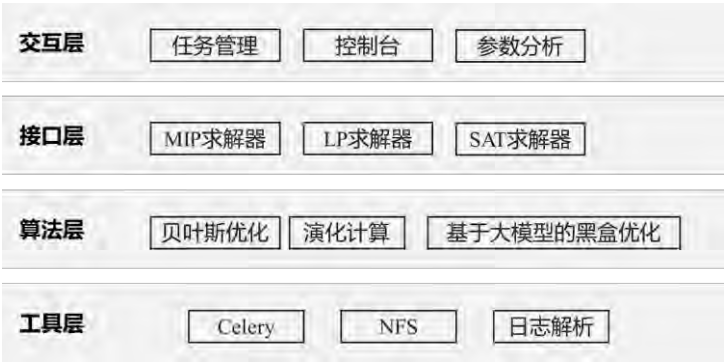
图2.42 求解器超参优化软件架构
