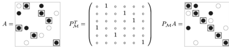
图2.31 重排流程示意图
