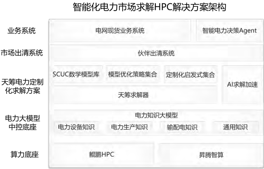
图4.41 天筹求解器智能化电力市场求解HPC解决方案
