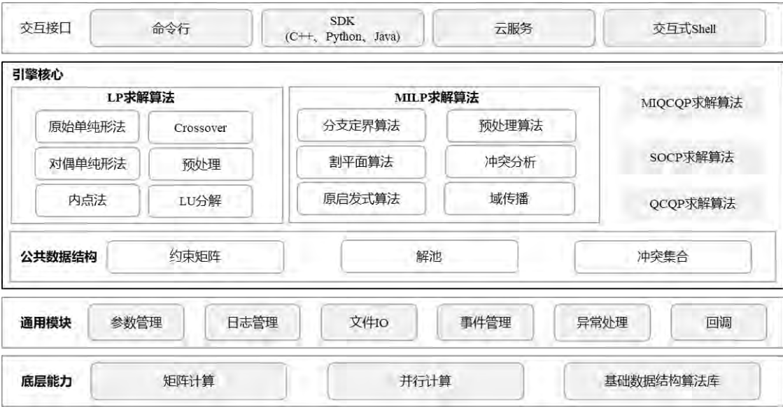
图2.1 数学规划求解器软件架构
