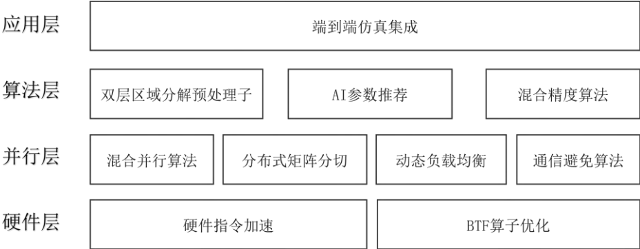
图4.44 天筹数值计算求解器技术架构
