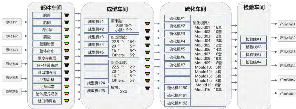
图4.4 轮胎生产流程示意图
