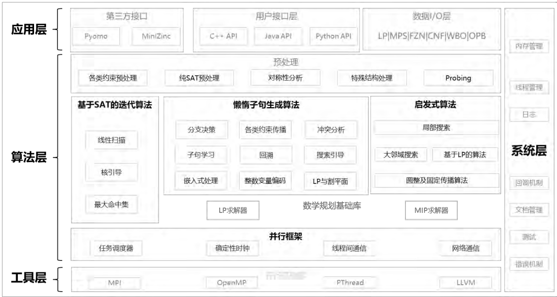
图2.9 约束规划求解器软件架构
