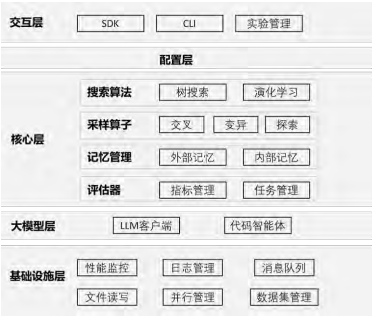
图2.50 基于大模型的算法发现软件架构
