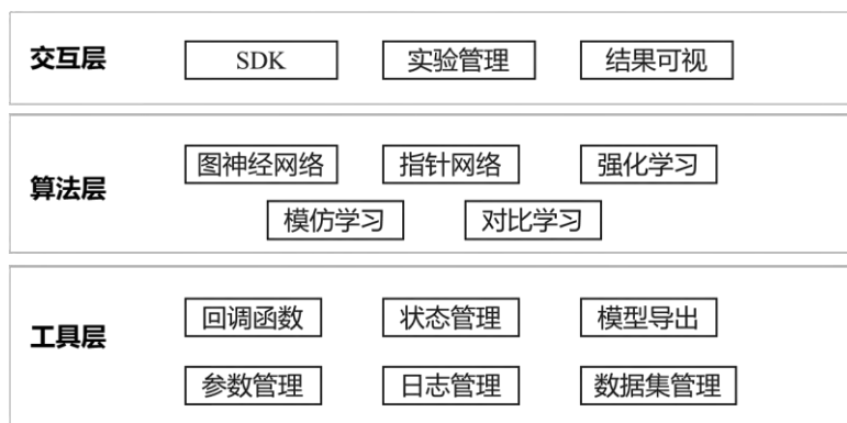
图2.46 求解器AI策略嵌入软件架构
