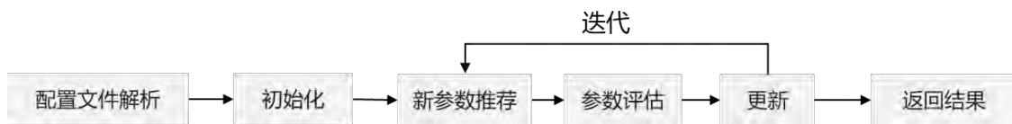
图2.44 超参优化算法流程
