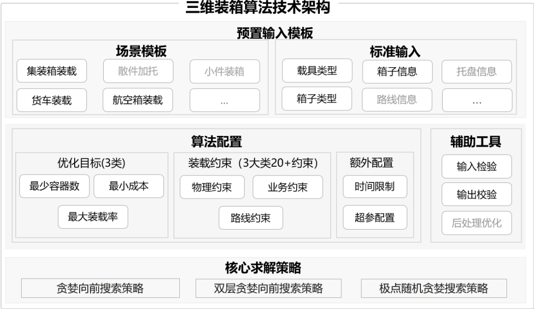
图3.15 三维装箱求解器技术架构图
