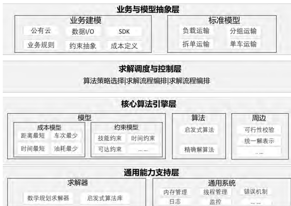
图3.9 运输计划求解器软件架构图
